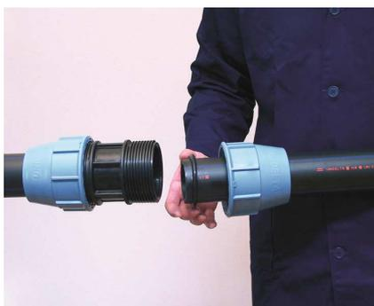
3. Надеть на трубу сначала интегрированный компонент и далее, уплотнительную прокладку. Будет полезно произвести смазку конечного участка трубы силиконовой смазкой или любой другой смазкой, которая не влияет на качество питьевой воды.
